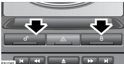
Pour verrouiller ou déverrouiller le véhicule, appuyez sur le bouton correspondant de la planche de bord. Ces boutons commandent toutes les portes et le hayon.
