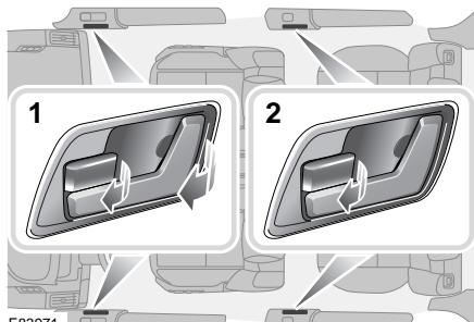
1. Les portes avant peuvent être déverrouillées en actionnant les boutons de verrouillage ou déverrouillées et ouvertes à l'aide des poignées intérieures.
