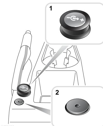
Le connecteur d'équipements auxiliaires se trouve à l'arrière de la console centrale.
