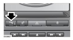
Pour activer manuellement l'aide au stationnement avant, appuvez sur le bouton de PDC. Une brève tonalité est alors émise et le témoin du bouton s'allume pour indiquer que le système PDC est activé.
