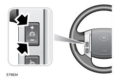
Quand le HDC est sélectionné, la vitesse en descente peut être modifiée à l'aide des commutateurs du régulateur de vitesse du volant. Le commutateur + augmente la vitesse tandis que le commutateur – la réduit.
