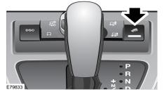
Le HDC peut être sélectionné à une vitesse inférieure à 80 km/h (50 mi/h). Pour ce faire, appuyez brièvement sur le commutateur de marche/arrêt du HDC.
