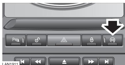
Pour désactiver le système (empêcher le démarrage/arrêt automatique), appuyez sur le bouton **ECO**. Le témoin s'éteint pour confirmer la désactivation du système.
