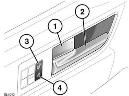
Vom Fahrgastraum aus können durch Drücken des Verriegelungshebels (1) auf der Fahrer- oder der Beifahrerseite alle Türen verriegelt werden.
