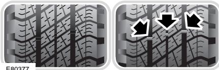
Ist das Profil auf ungefähr 2 mm abgefahren, werden die Verschleißanzeiger auf der Oberfläche des Profils sichtbar. Als visueller Hinweis kommt quer über den Reifen ein durchgehendes Gummiband zum Vorschein.
