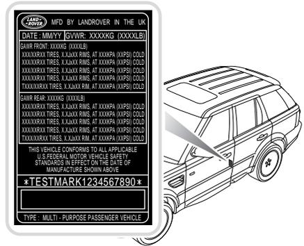
Le numéro d'identification du véhicule (VIN) et les charges maximales recommandées pour le véhicule sont gravés sur une plaque rivetée en bas du côté serrure de la porte avant gauche (porte avant droite en Chine). Le VIN gravé doit correspondre au VIN inscrit dans le livret de service et au VIN visible à travers le pare-brise avant.
