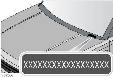
Pour décourager les voleurs potentiels et aider la police, le VIN est gravé sur une plaque visible à travers le pare-brise, en bas à gauche (le numéro indiqué doit être identique à celui enregistré dans le livret de service). Vous pouvez également trouver le VIN, entre autres, sur la plaque de verrouillage du capot, le pylône d'alignement et les panneaux de passage des roues.
