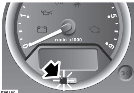
Der Alarmanlagenzustand wird durch die Alarmanlagenleuchte im Tachometer angezeigt.
