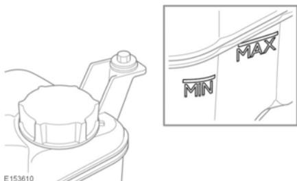
Le niveau de liquide de refroidissement doit rester compris entre les repères **MIN** et **MAX** sur le côté du vase d'expansion.
