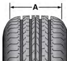
A - Bande de roulement du pneu.
