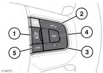
1. **LIM** : appuyez sur ce bouton pour passer du régulateur de vitesse à l'ASL. Le témoin ASL s'allume lorsque l'ASL est actif. Le régulateur de vitesse et l'ASL ne peuvent pas être utilisés simultanément.
