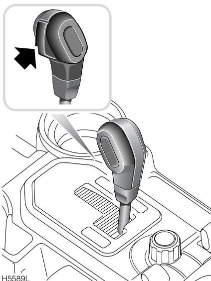
**Note :** La clef de contact ne peut être enlevée QU'APRES avoir placé le sélecteur de vitesses en position "P".
