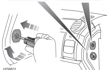
Du côté passager, ouvrir la porte avant et insérer la clef de contact dans l'interrupteur de neutralisation d'airbag. La faire tourner en position de coupure "OFF".
