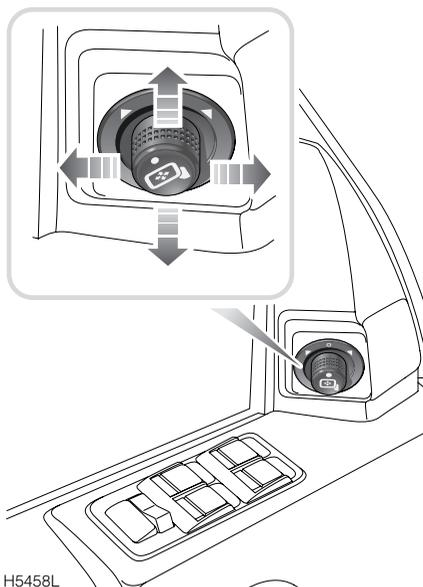
Le contacteur à clef étant en position "I" ou "II", pousser le bouton dans le sens approprié pour orienter la glace du rétroviseur vers le haut, le bas, la gauche ou la droite.
