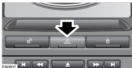
Si le véhicule est arrêté dans un endroit peu sûr ou pouvant présenter un danger pour les autres usagers de la route, allumez les feux de détresse. Pour allumer les feux de détresse, appuyez sur le commutateur.
