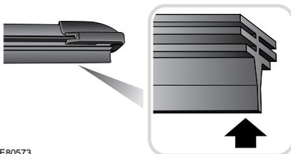
Contrôlez et nettoyez régulièrement la lame des balais d'essuie-glaces. Vérifiez que le caoutchouc de la lame ne présente pas de traces de craquelure, fissure ou rugosité. Si de telles traces sont visibles, remplacez immédiatement le balai pour éviter d'endommager la vitre.
