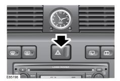
Si le véhicule est arrêté dans un endroit peu sûr ou pouvant présenter un danger pour les autres usagers de la route, allumez les feux de détresse. Pour allumer les feux de détresse, appuyez sur le commutateur.
